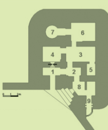
Bunkier typu Regelbau 120a – Pohulanka
